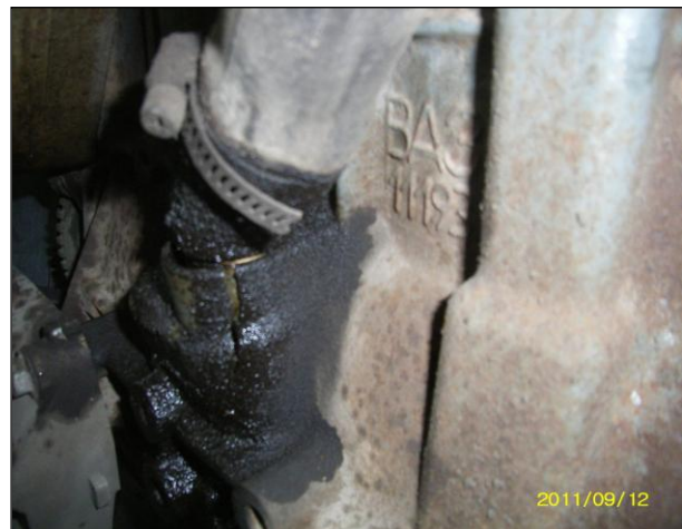
Рис. 4. Пробитая разрушившимся поршнем стенка блока цилиндров двигателя ВАЗ-21126
