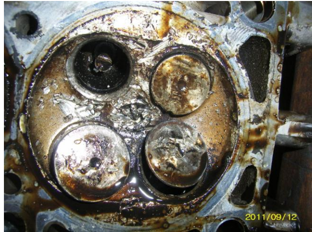
Рис. 2. Деформация камеры сгорания головки двигателя ВАЗ-21126 в результате обрыва тарелки клапана
