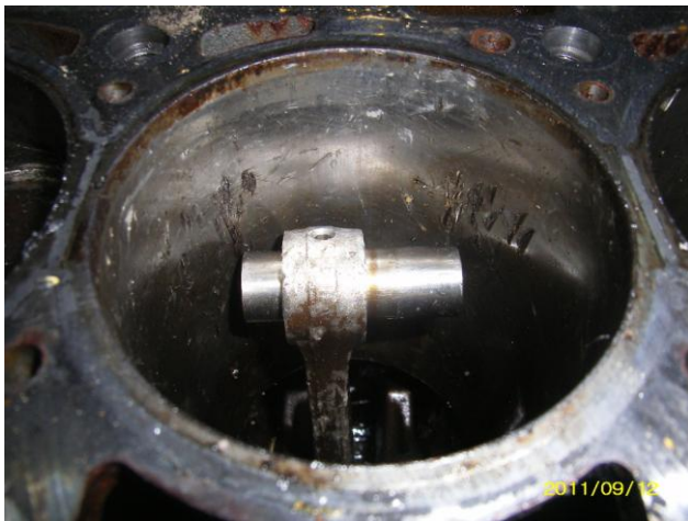
Рис. 3. Разрушение поршня двигателя ВАЗ-21126 в результате обрыва тарелки клапана
