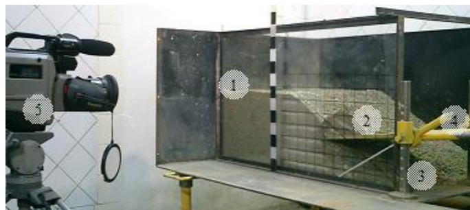
Рис. 1. Экспериментальная установка для физического моделирования взаимодействия элементов ковша с погружаемой средой: 1 — бункер; 2 - поворотная плита; 3 — стойки; 4 — подшипниковые узлы; 5 — видеокамера
