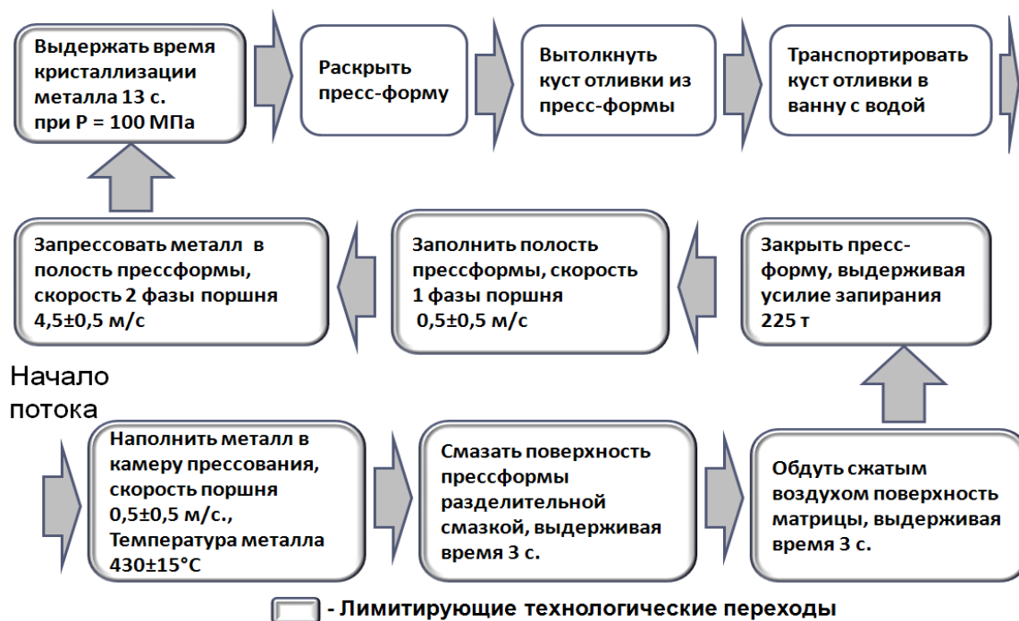
Рис. 3. Технологические переходы получения куста отливки
