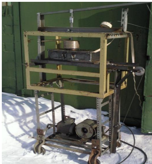
Рис. 1. Экспериментальный сдвиговой стенд для исследования влияния нагрева на прочность смерзания грунта с металлом
