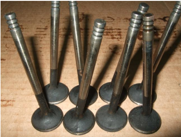
Рис. 1. Деформированные клапана двигателя ВАЗ-21126 в результате разрушения опорного ролика
